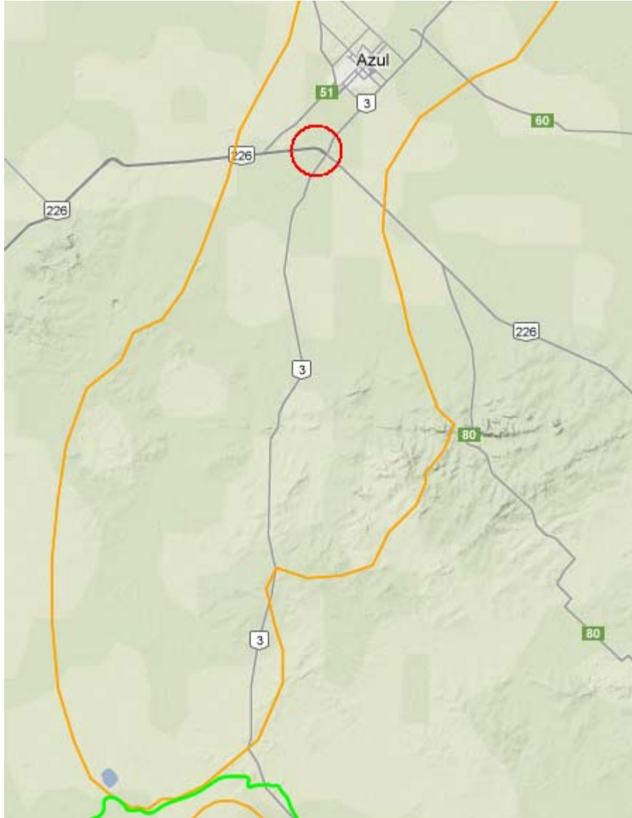
Figura 16: Detalle de la cuenca alta y media del Ao. Azul y sus principales accesos. Se indica con un círculo rojo la zona donde escurre el agua que no es evacuada por canales a lo largo de la ruta.
